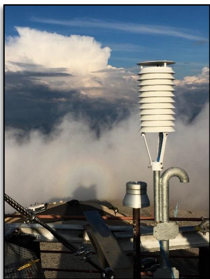
Image 1 : Sonde de température - tour Orange France Télécom
